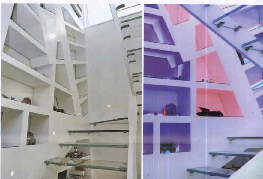
La libreria è retroilluminata a LED e una serie di piccoli proiettori fa da segnapasso lungo la scala; l'attivazione è demandata a un sensore di presenza
